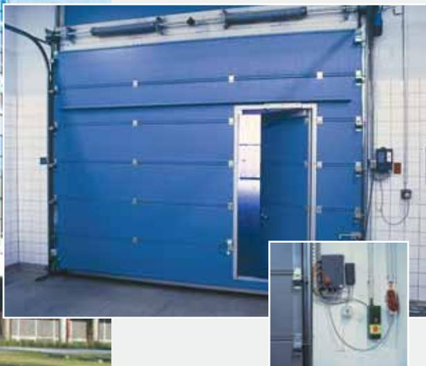
Viele Tore sind mit zusätzlichen Schlupftüren ausgestattet, die den Durchgang auch bei geschlossenem Tor ermöglichen. Die elektrische Abtastung lässt Torbewegungen nur bei geschlossener Schlupftür zu.
